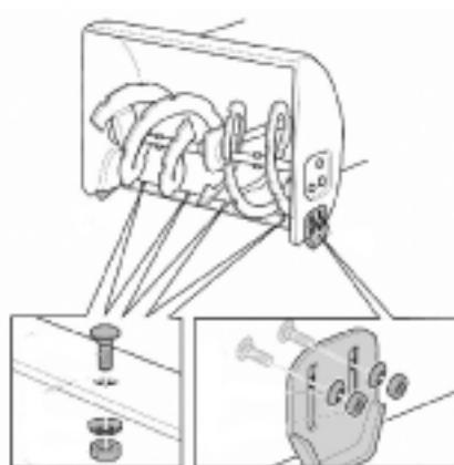
Отрегулируйте положение ограничительных башмаков (10) так, чтобы шнек(9) не касался очищаемой поверхности. При регулировке учитывайте то, на какой поверхности будет использоваться снегоуборщик. На неровных и не твердых поверхностях устанавливайте максимальную высоту, на твердых и ровных минимальную.
